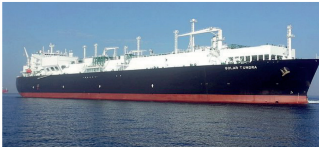
La nave Golar Tundra è lunga 292 metri e larga 43 metri. Può stoccare circa 170.000 metri cubi di gas naturale liquefatto a -160° e rigassificare 5 miliardi di metri cubi di Gnl all'anno
